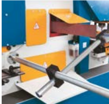
Hinteranschlag mit automatischer Schnittausslösung
