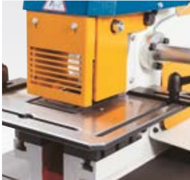
Auslinkstation mit Schutzeinrichtung
