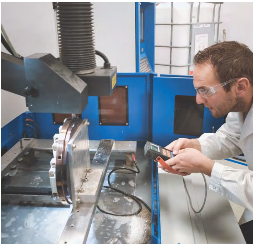
Für eine perfekte Trennung wird die Werkstückgeometrie eingelernt. Hier wurde eine Bauplattform mit Bauteilen aus Edelstahl bearbeitet.
