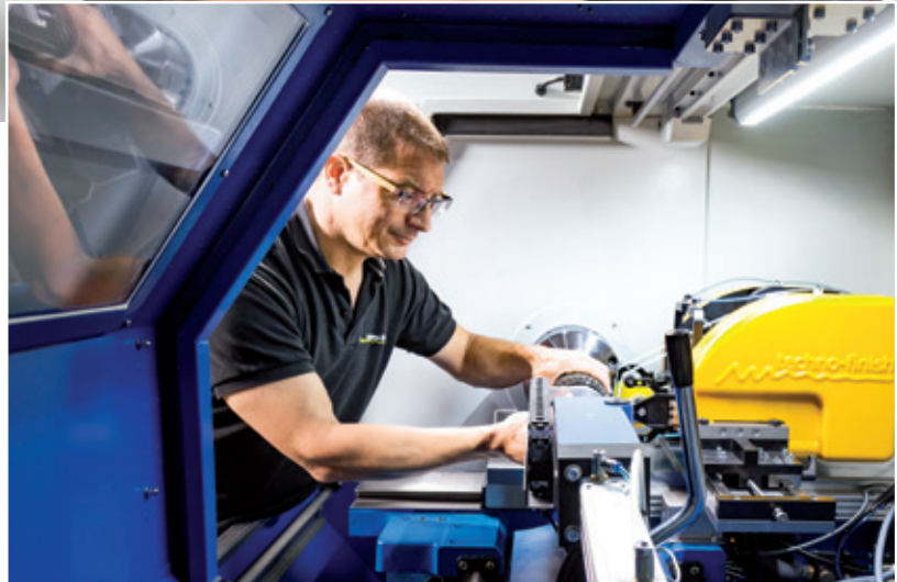
Einrichtungsarbeiten an der Siemens 828D Steuerung der CNC-Drehmaschine mit integriertem Bandfinisher
