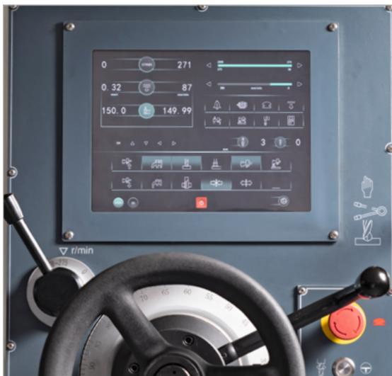
Die Bohrtiefe wird elektronisch gesetzt und der Eingabewert vom System geprüft. Der Vorschub kann auf der Anzeige auf zwei Arten angezeigt werden: Vorschub pro Umdrehung und Vorschub pro Minute.
