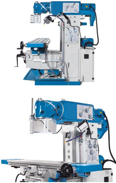
Die Vertikal- und Horizontalspindeln verfügen jeweils über einen separaten Antrieb
